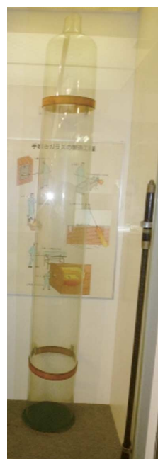
図3 手吹き円筒と吹棒（化学遺産） 旭硝子(株)京浜工場蔵
