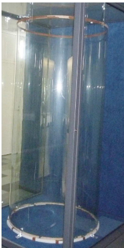
図4 機械吹き円筒 (化学遺産) (旭硝子(株)研修センター所蔵)
